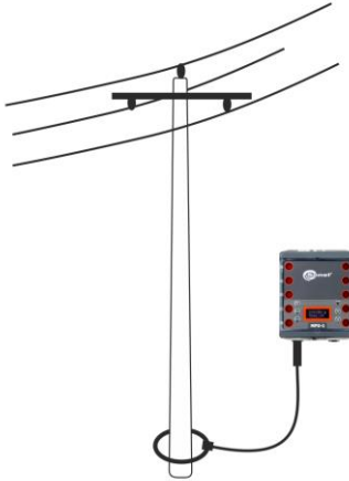
Fig. 9. Funcionamiento del dispositivo con el uso de las pinzas singulares
