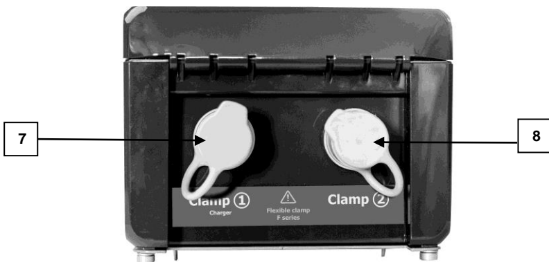
Fig. 2. Distribución de enchufes en el señalizador MPU-1.
