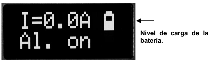
Fig. 7. Seguimiento del estado de carga de batería
